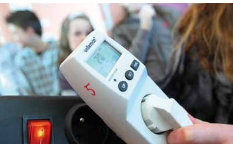
Mesure de la consommation cachée des ordinateurs
