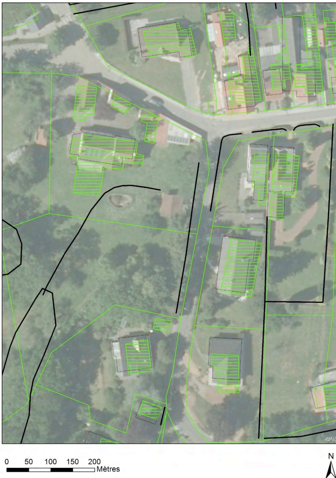
**Figure 55 : Superposition du parcellaire cadastral (les limites des parcelles cadastrales ainsi que les bâtiments sont représentés en vert), du PICC (les éléments visibles délimitant potentiellement les propriétés foncières sont représentés en noir) et d'un orthophotoplan (orthophotos 2012-2013 du SPW).**
