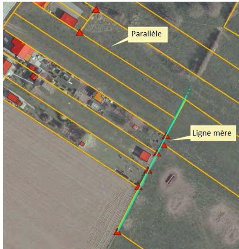
**Figure 49 : Exemple d'une modification apportée à une étape de la réinterprétation à posteriori. Dans l'étape 2, par manque de points de références, la ligne mère a été construite mais un petit peu trop longue (cfr. la portion en pointillés bleus). C'est seulement en étape 3 que la ligne mère a pu être dessinée complètement en définissant l'extrémité de cette ligne comme l'intersection avec la parallèle redessinée.**
