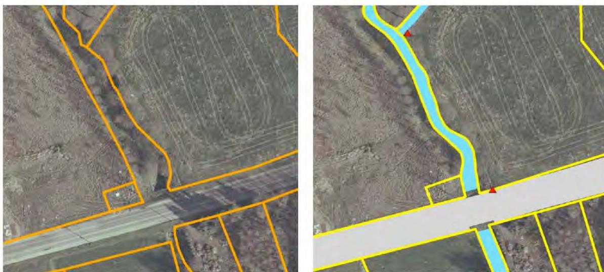
**Figure 42 : Réinterprétation d'une parcelle cadastrale sur base de la forme de la forme d'un cours d'eau.**
