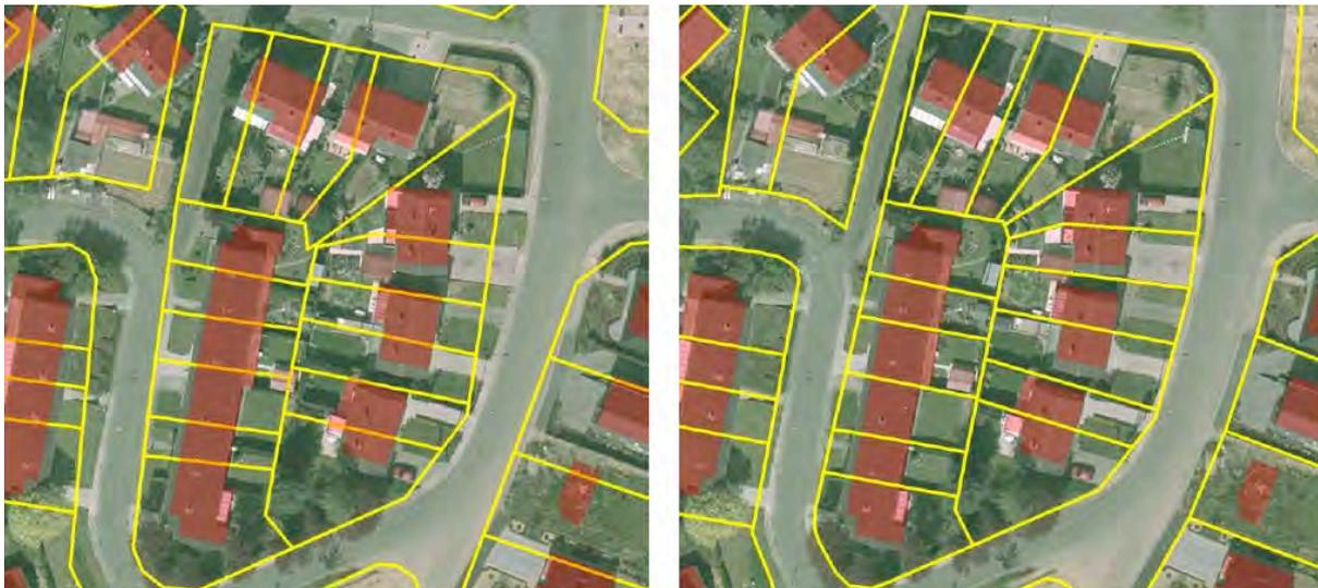
**Figure 24 : Reconstruction et repositionnement de parcelles foncières (situation avant manipulation à gauche, situation après à droite).**
