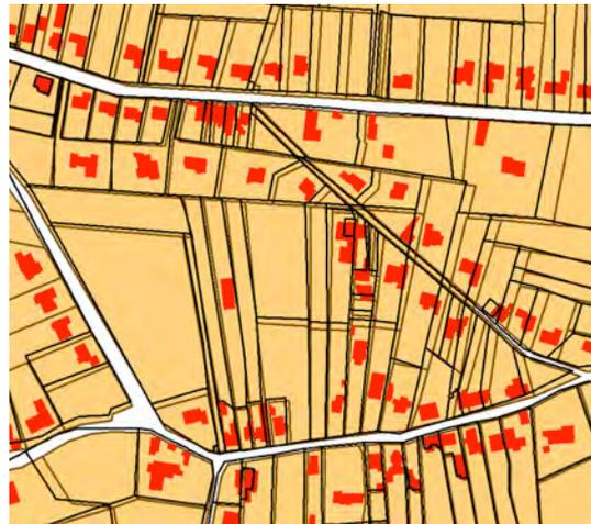
Figure 14 – Superposition du PLI (contours noirs) et du Cadastre (parcelles beiges aux contours bruns).
