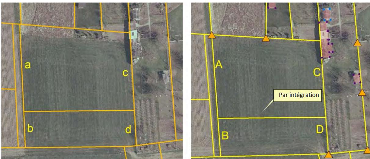
Figure 36 : Intégration d'une limite de parcelle dans le cas où il n'existe aucun point ou limite de référence. A gauche, on observe des parcelles CADMAP. A droite, on observe la parcelle administrative reconstruite. La limite horizontale au centre a été intégrée. Pour cela, les rapports  $a/b$  et  $c/d$  ont été respectés ( $a/b = A/B$  et  $c/d = C/D$ ).
