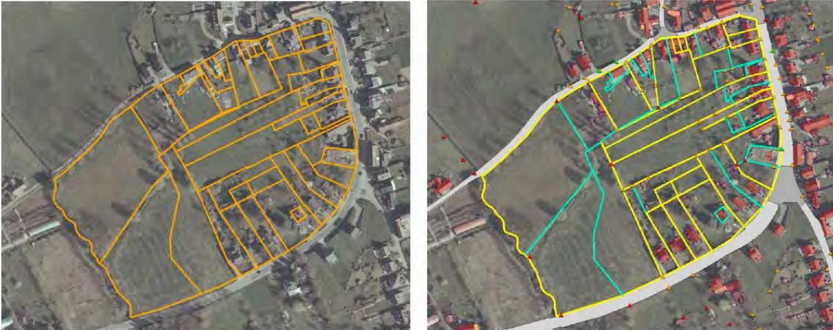
**Figure 48 : Réinterprétation des dernières limites de parcelles manquantes dans le bloc (en bleu sur l'image de droite).**
