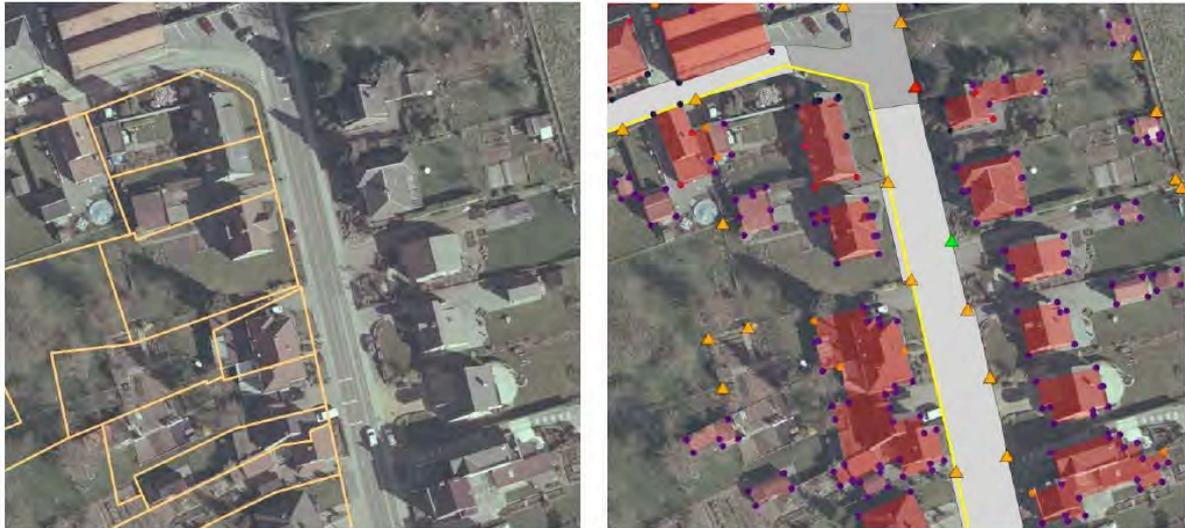
**Figure 39 : Retrait d'un petit coude dans le coin du bloc de parcelles. Ce coude (visible dans le parcellaire cadastral à gauche) est retiré du bloc de parcelles réinterprété (visible à droite).**
