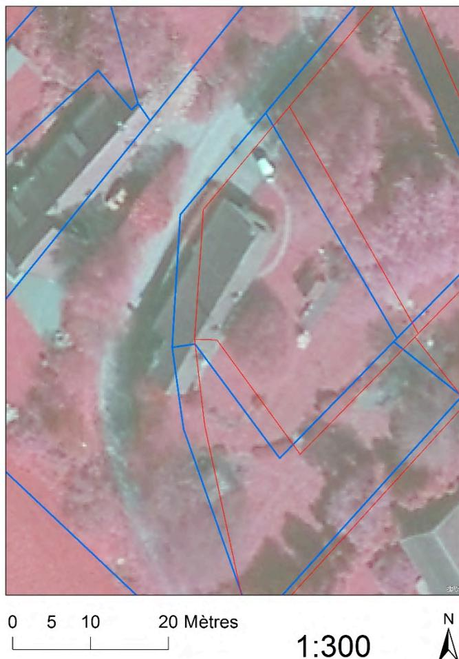
**Figure 70 : Superposition du parcellaire cadastral de moindre qualité en zone rurale (en rouge), du PLI (en bleu) et d'un ortho 2012-2013 du SPW (en infra-rouge).**
