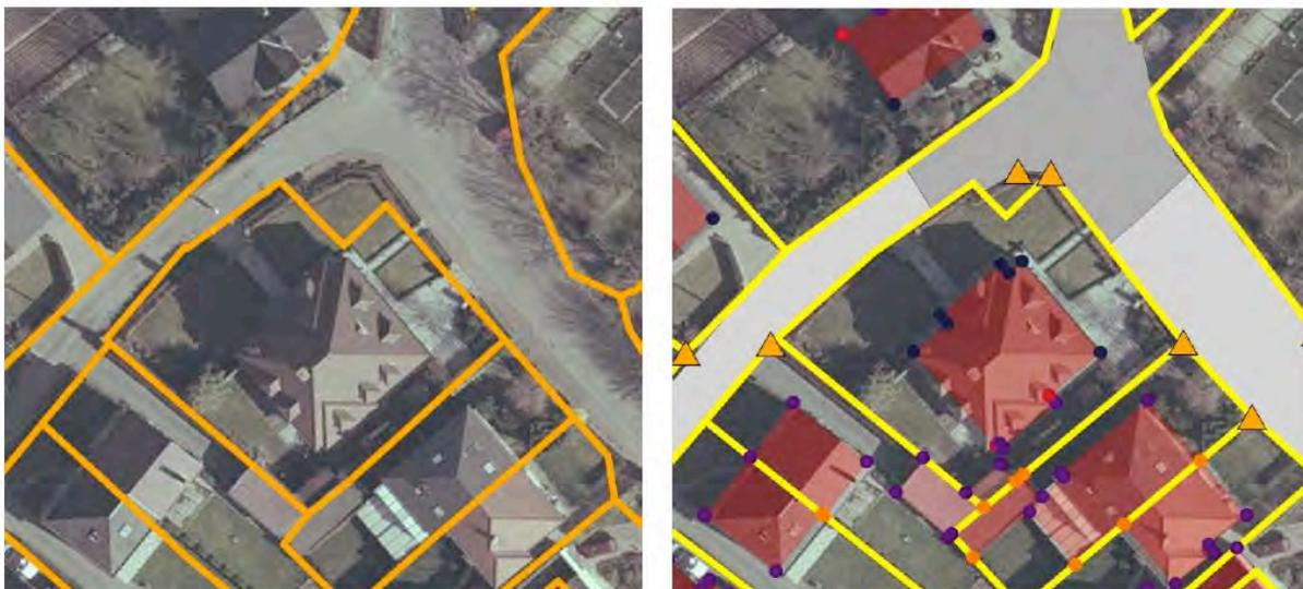
**Figure 43 : Maintien de la forme anguleuse d'une parcelle cadastrale lors de la réinterprétation. Bien que l'orthophotoplan laisse voir que le propriétaire ne respecte pas cette forme anguleuse dans sa façon d'exploiter sa parcelle.**
