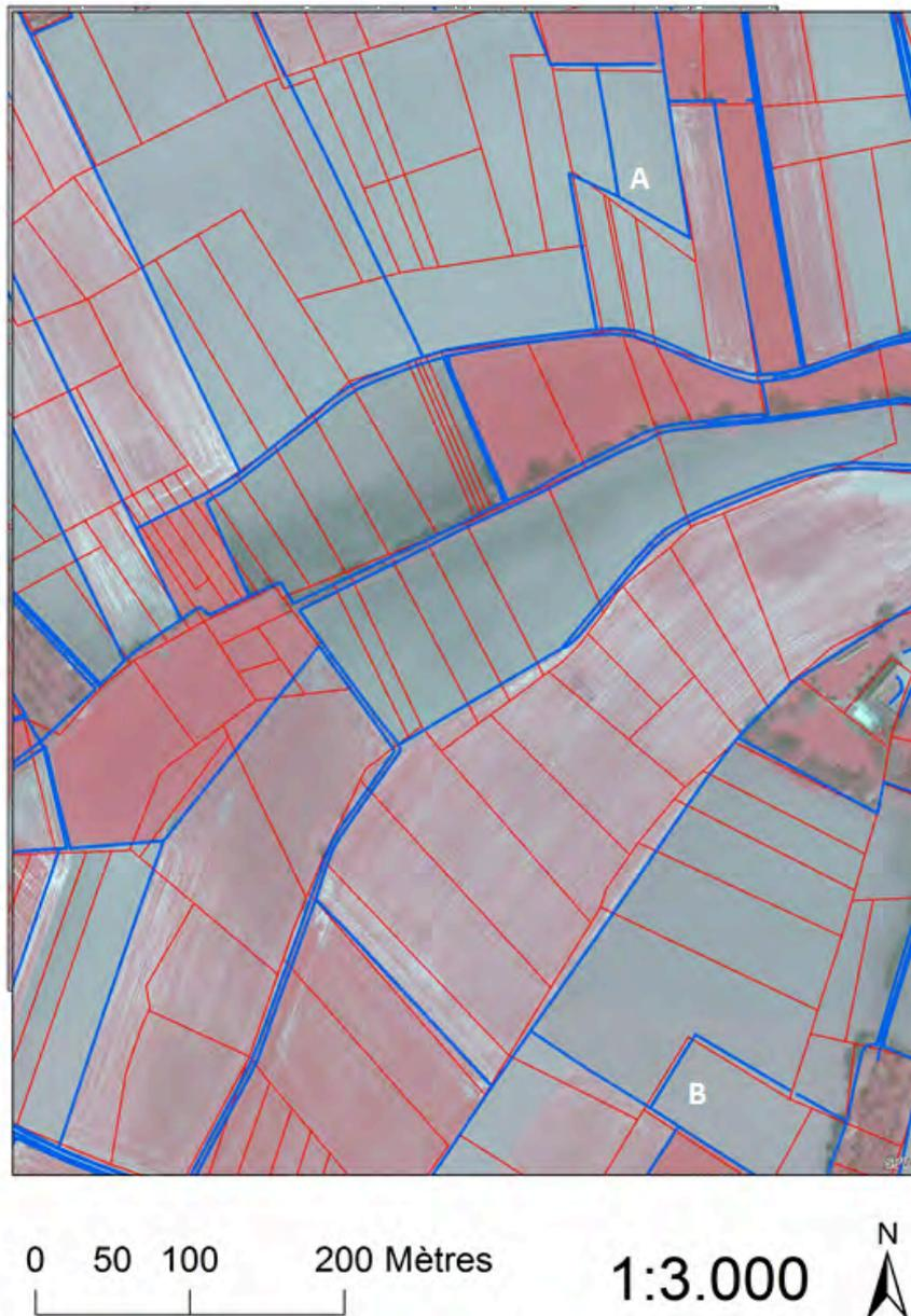
**Figure 72 : Superposition du parcellaire cadastral de moindre qualité en zone rurale (en rouge), du PICC (en bleu) et d'un ortho 2012-2013 du SPW (en infra-rouge). Autour des points A et B, on observe des limites dans le PICC qui semble suivre le tracé des limites de parcelles foncières.**
