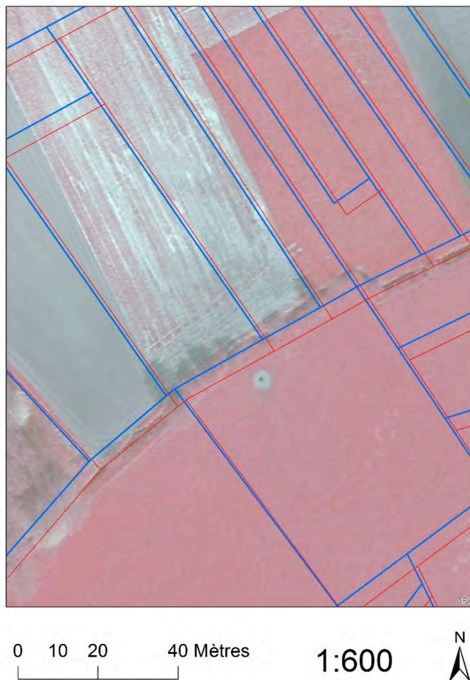
**Figure 68 : Superposition du parcellaire cadastral de moindre qualité en zone rurale (en rouge), du PLI (en bleu) et d'un ortho 2012-2013 du SPW (en infra-rouge).**
